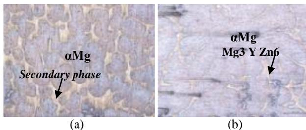
Gambar 5. Struktur mikro paduan Mg-6Zn-1Y dengan perbesaran 50x
